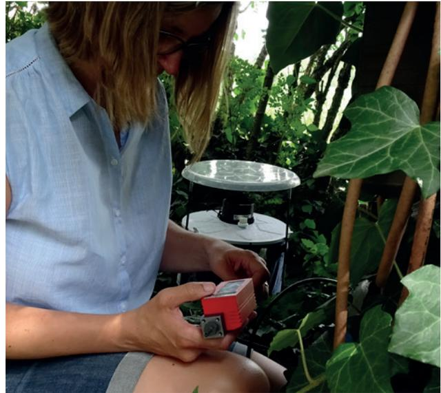
Eine Biogents-Mitarbeiterin überprüft den CO<sub>2</sub>-Gasfluss mit Hilfe eines red-y compacts
