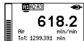
**Reset:** Ein ausgelöster Alarm kann mittels Reset manuell zurückgestellt werden (eine weitere Möglichkeit zum Zurückstellen ist auf der entsprechenden Alarm-Hauptseite). Ein ausgelöster Alarm wird dort mit einem Zahnrad (⚙️) hinter dem Wort **“Reset”** angezeigt.
