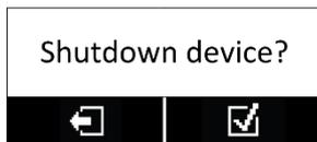
Ist Ihr Gerät batteriebetrieben, haben Sie im Menü die Funktion „Power off“. Diese Funktion ist nur im Batterie-Modus möglich und schaltet das Gerät komplett aus. Das Messgerät schaltet wieder ein, sobald Sie die Anzeige länger als 3 Sekunden berühren. In ausgeschaltetem Zustand
