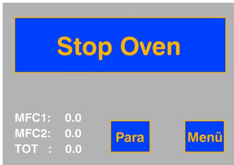
Nun kann der Ofen jederzeit durch Druck auf die Stop-Taste ausgeschaltet werden. Er wird ebenfalls sofort ausgeschaltet, wenn das System eine Schlecht-Bedingung erkennt.
