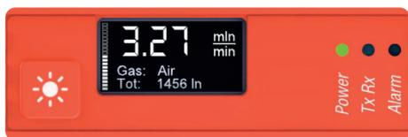
Fig.1 Afficheur SPOT avec paramètres standards
