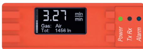
Abb.1 Anzeige SPOT mit Standardparametern
