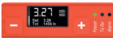
Abb.2 Anzeige SETSPOT mit Standardparametern und +/- Wahlstasten zum Anpassen vom Sollwert
